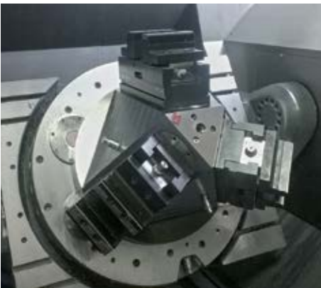
3台のMC-Pを120°ピッチに傾斜させて配置した、5軸マシンニングに最適なクランプシステム
